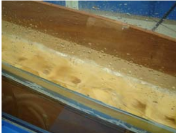
写真 3 魚道内を射流で流下する流況 ( d_c/h = 0.195 , S/h = 1.00 , L_f/b = 0.90 )
