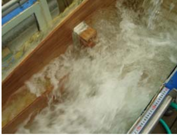
写真 6 魚道内で潜り込み流れが形成される流況 ( d_c/h=0.650 , S/h=1.00 , L_f/b=0.90 )
