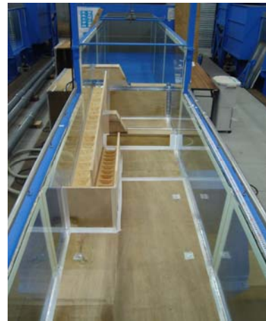
写真1 実験に用いた折り返し魚道模型
