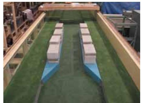
写真-1 狭窄部の有する実験水路
