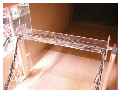
図3 風洞内に設置した圧力模型
