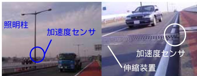
図5 振動計測状況
