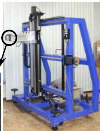
**図-3** 表面粗さ計測機
