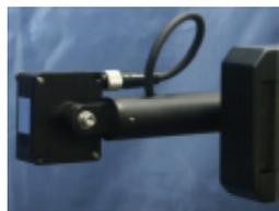
**図-2** レーザー変位計
