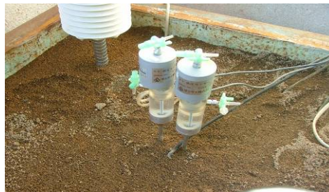
図1 SK 型圧力式テンシオメータを用いた実験の様子
