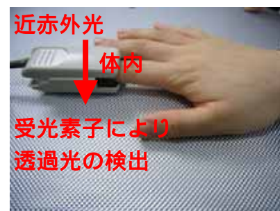
図-1 脈波測定の原理
