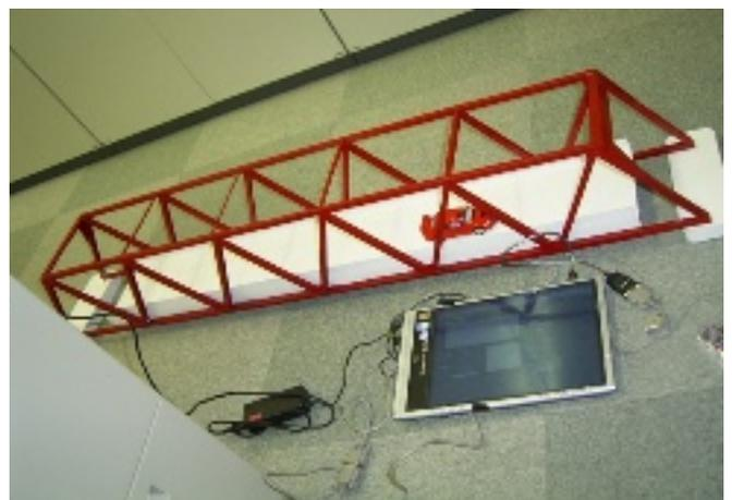
図4 加速度センサと PC 接続
