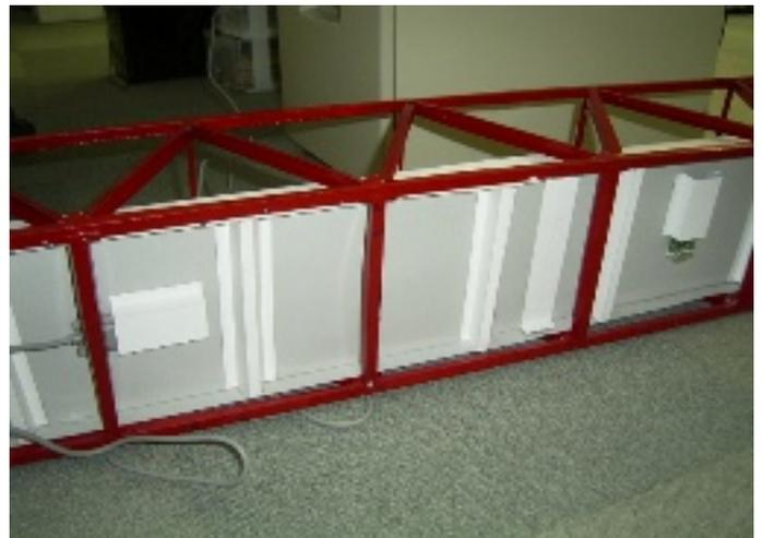
図3 橋梁模型への加速度センサ取り付け
