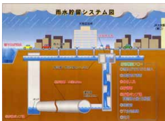
図 - 1 雨水貯留システム
