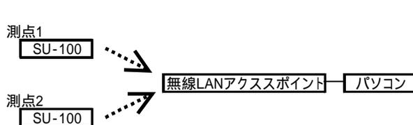
図-1 無線 LAN 振動計システム構成例
