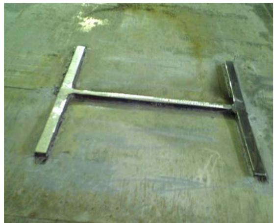
写真-2 切断砥石工法による切断面
