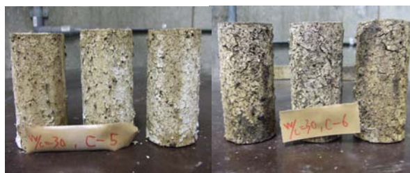
写真-2 加熱後の供試体 (W/C=30% : 左 c-5, 右 c-6)
