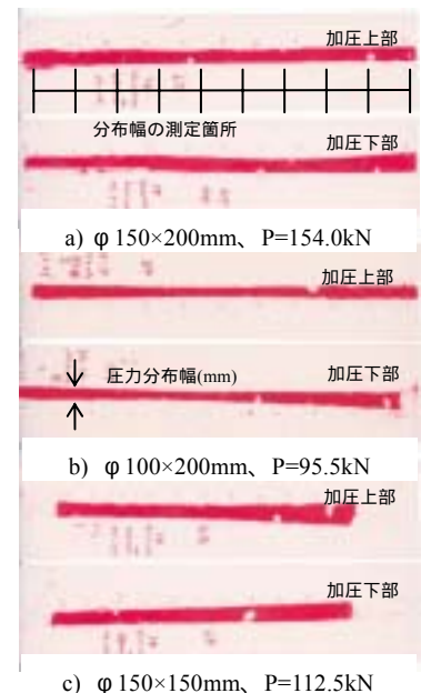
図-3 供試体の加圧部の圧力分布幅測定 の一例(W/C=60%、材齢 28 日)
