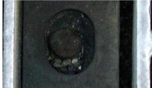
写真1 ボルトの破断
