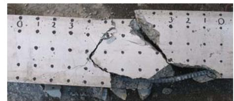
写真-2 破壊状況(高速載荷時)
