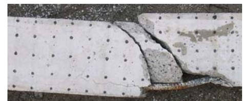
写真-1 破壊状況(静的載荷時)
