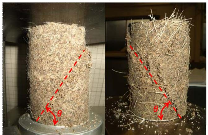
写真-1 圧縮試験後の供試体
