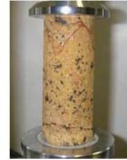
図 4 一軸圧縮試験不攪乱供試体
