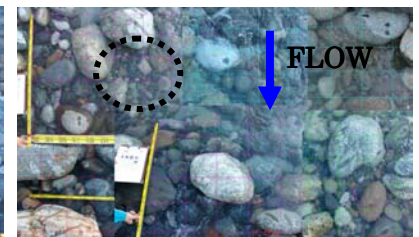
写真-2 大きな掃流力で安定した河床面の状態
