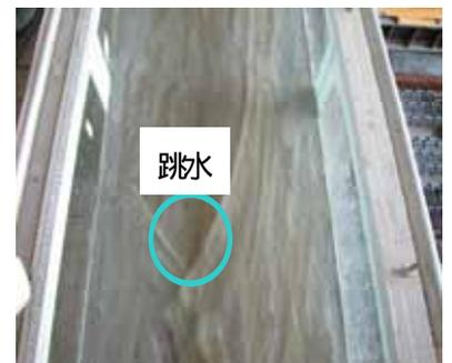
図-4 縦断的な常射混在流れ
