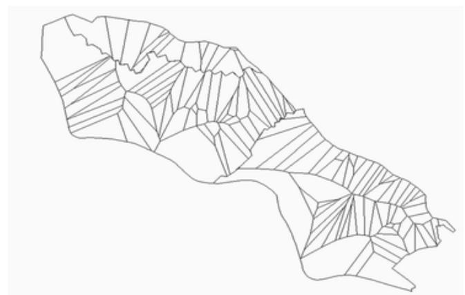
図-4 幾何学的に分割した(ティーセン分割)集水域平面図
