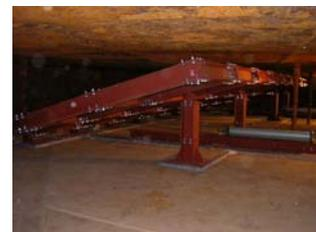
写真 2. タンク内に設置した造波装置
