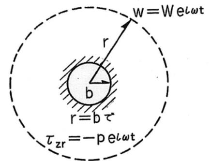
図1 地盤ばね算定の解析モデル
