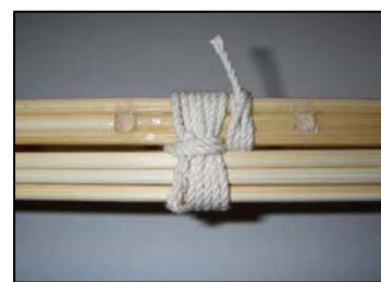
図3. 梯子の組み立て図
