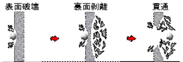
図-3 局部破壊の種類
