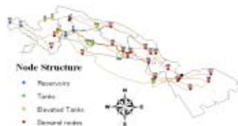
図 3. 幹線管網のノードモデル
