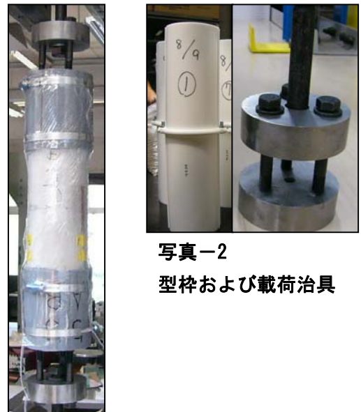
写真-1 載荷時の供試体
