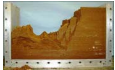
写真 - 1 崩壊した模型地盤
