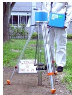
写真-4.1 簡易地盤支持力試験
