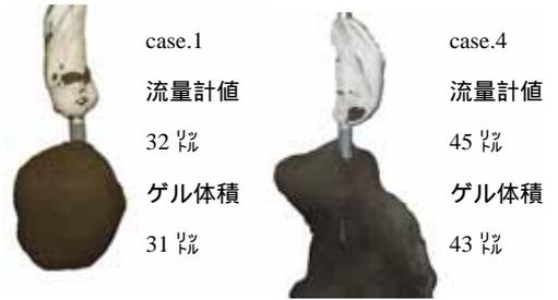
写真-2 ゲルの塊状固結体(case.1)
