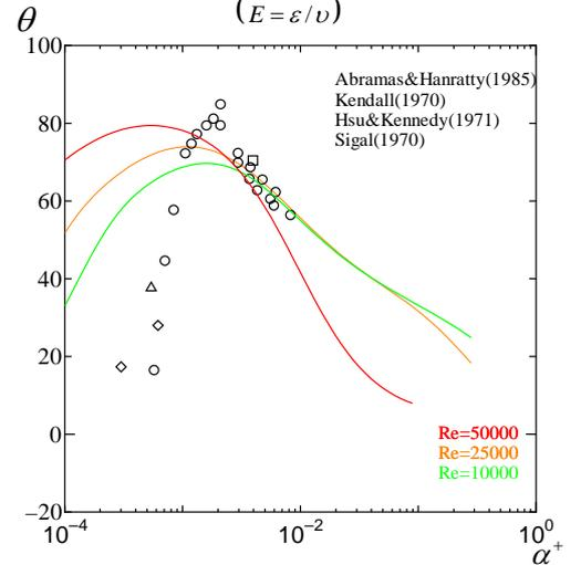
図-3 滑面における位相差の $\alpha^+$ 方向分布
