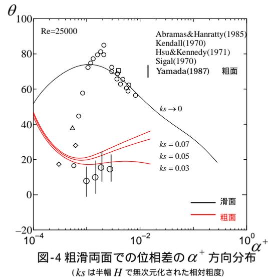
図-4 粗滑両面での位相差の $\alpha^+$ 方向分布 ( $ks$ は半幅 $H$ で無次元化された相対粗度)
