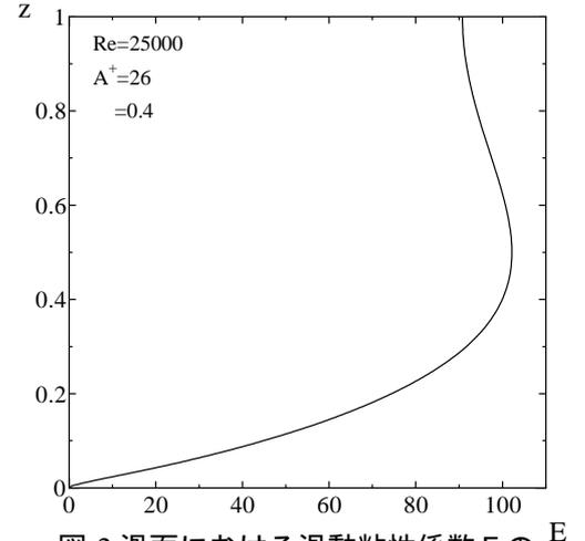
図-2 滑面における渦動粘性係数 $E$ の $z$ 方向分布 ( $E = \varepsilon/\nu$ )
