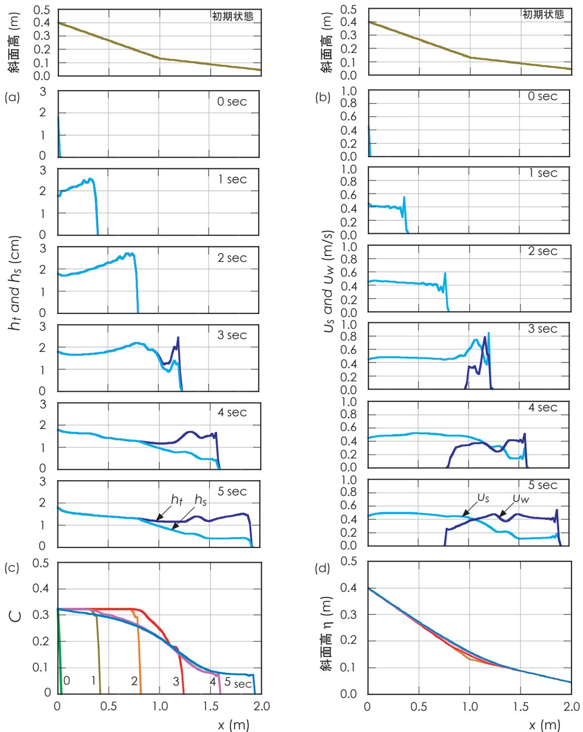
図-1 数値解析結果：(a) 全層水深  $h_t$  と土砂層の層厚  $h_s$ ，(b) 土砂層ならびに水流層の平均流速  $u_s$  および  $u_w$ ，(c) 全層平均の土砂濃度  $C$ ，(d) 斜面高  $\eta$  の時間変化
