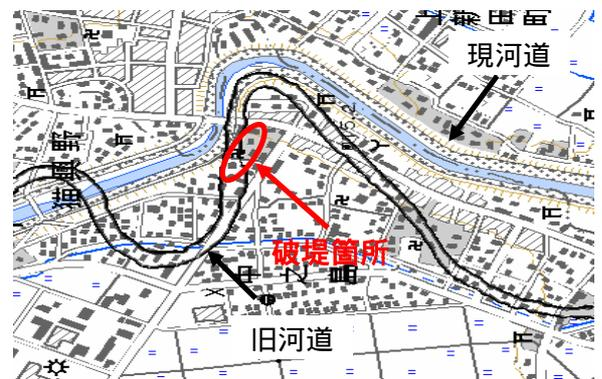
図7 明治44年<sup>6)</sup>と現在<sup>6)</sup>の刈谷田川破堤箇所
