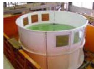
写真1. タンクモデル振動実験
