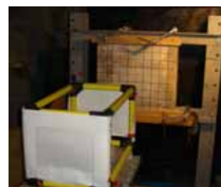
写真-1 コンクリート板と速度検知システム
