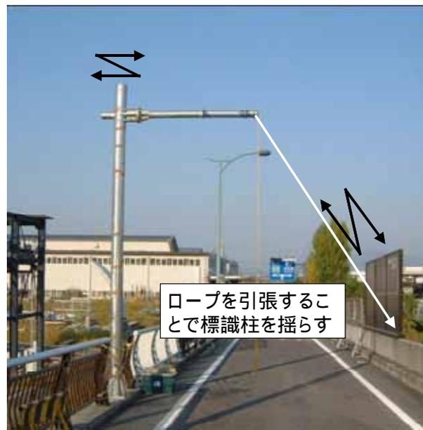
図-4 標識柱加振状況
