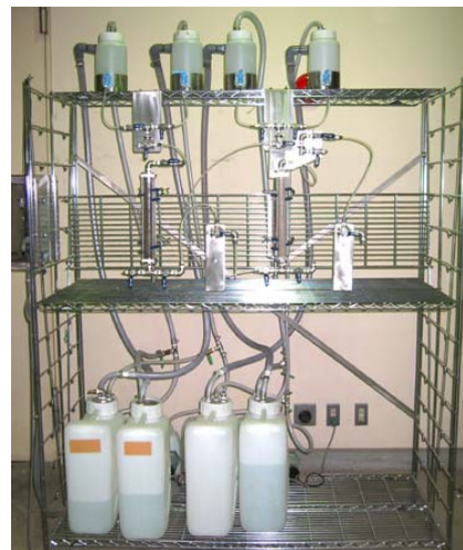
写真-1 カラム試験機概要図
