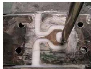
図 7 裏込材充填完了
