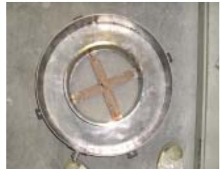
写真 1 リング試験用型枠
