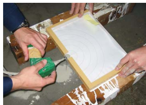
写真 2 注入実験の様子
