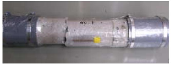
写真-2 破断状況 (材齢 57 日, W/C=35%)
