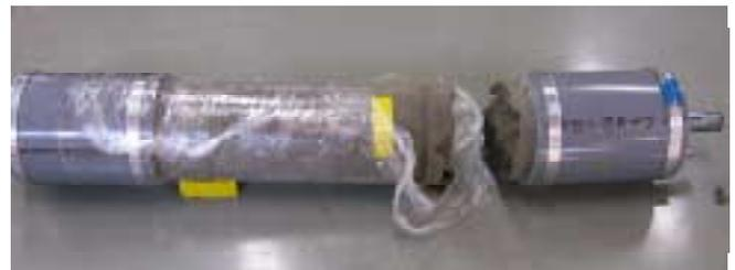
写真-3 破断状況 (材齢 1 日, W/C=55%)
