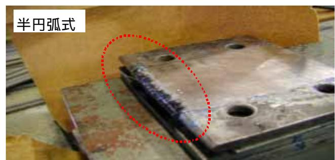
写真-1 CFS の破断状況
