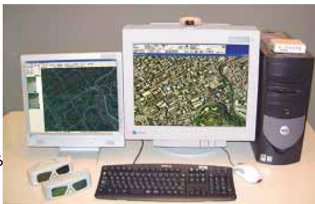
図-2 図化システム構成例
