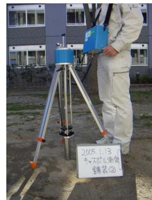
写真-1 簡易地盤支持力試験の測定状況
