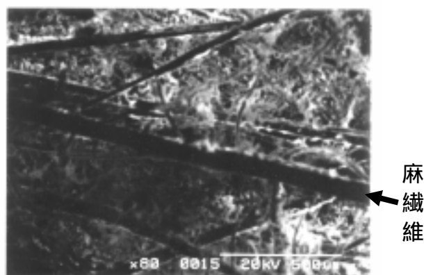
写真2 植生板顕微鏡拡大写真 古紙混合割合 50.0%，麻繊維 3 g 麻繊維あり
