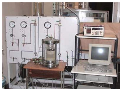
図-3 たわみ性壁透水試験機
