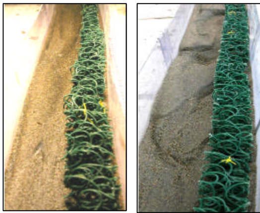
(a) 200\text{cm}^3/\text{s} (b) 400\text{cm}^3/\text{s} 写真-1 流量による河床形態の違い
