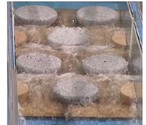
(b)円柱粗石前方で表面渦が形成され隙間を流れる流況( $s/d_c=2.14$ )
