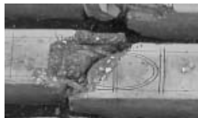
写真-1 ループ継手の破壊形状
