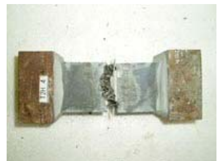
図-2 高速載荷における破壊状況
