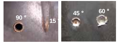
写真-1 鋼板の損傷状況(飛翔体 A)
