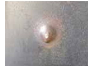
写真-2 鋼板裏面の膨らみ(飛翔体 B 60°)
